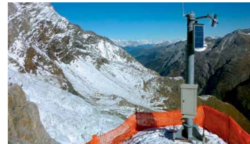
Le barrage de régulation de Port, près de Bienne, permet de gérer préventivement le niveau de l'Aar et des trois lacs du pied du Jura. L'appareillage placé sur un gradin escarpé du Bisgletscher, à l'aplomb de Randa (VS), déclenche l'alarme en cas d'avalanche ou de chute de glace.
