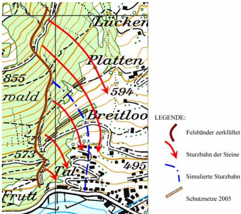
Abb. 7.1: Sturzbahnen der Steine und Lage der Schutznetze im Gebiet Tal.
