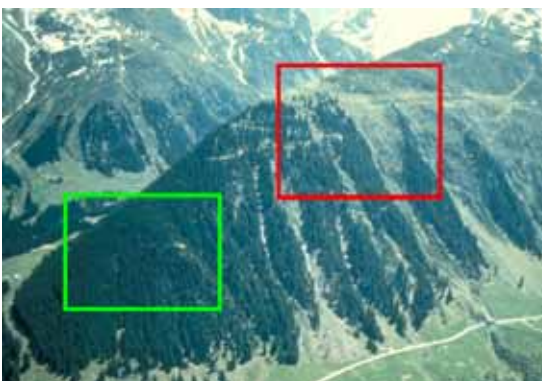
Abb. 3.5: Rechtes rotes Quadrat: Anrissgebiete oberhalb vom Wald und stark aufgelöster Wald: der Wald zeigt keine relevante Wirkung. Linkes grünes Quadrat: der Wald zeigt eine relevante Wirkung.
